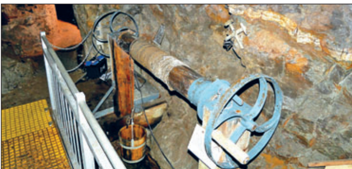
Historische Haspelanlage am großen Gesenk im Auroraerbstolln Fotos: Bergbautraditionsverein Aurora Erbstolln Dorfhain e.V.
